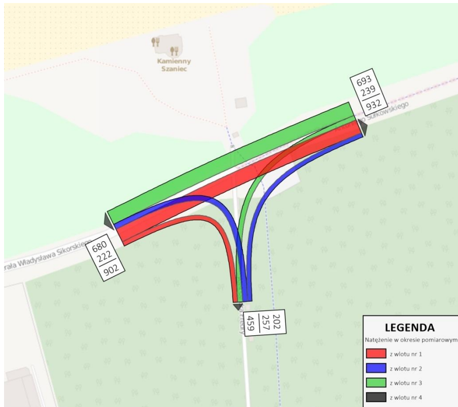
Rysunek 3.2 Suma liczby rowerzystów dla całego pomiaru w pkt. 2 źródło: opracowanie własne
