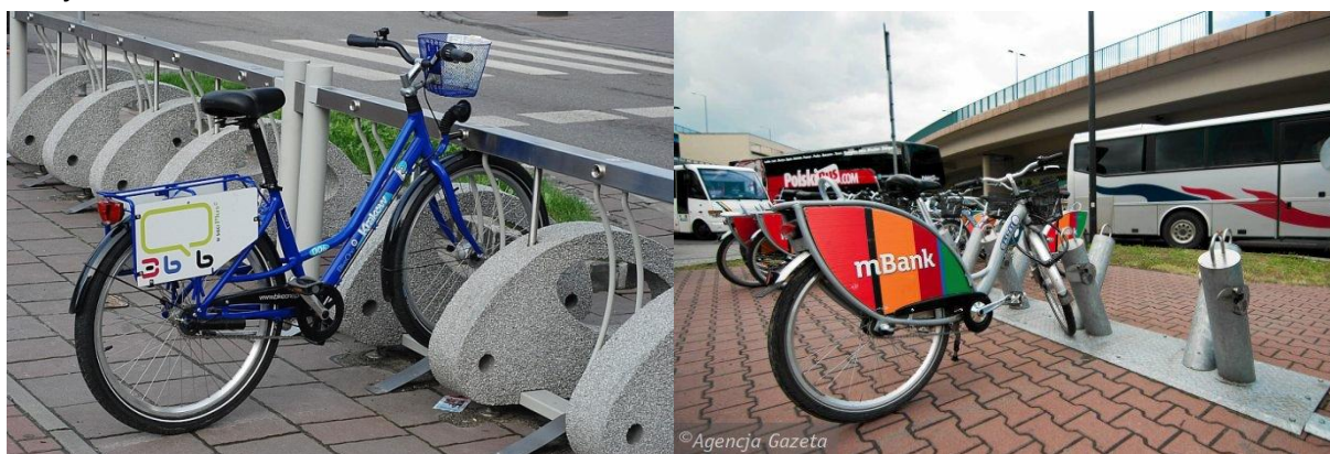
Rysunek 8.10 Przykład dokowania roweru z wykorzystaniem mechanizmu w rowerze źródło: www.wrower.pl oraz www.krakow.gazeta.pl
