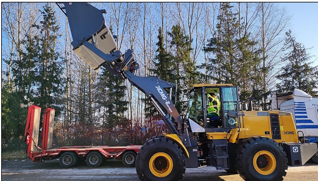
Rys. 3. Zdjęcie poglądowe ładowarka. Podwozie marki: XCMG; Typ/model: ZL50GV; Rok produkcji: 2021; silnik wysokoprężny z turbodoładowaniem, z bezpośrednim wtryskiem paliwa o mocy 162kW; udźwig 7 t
