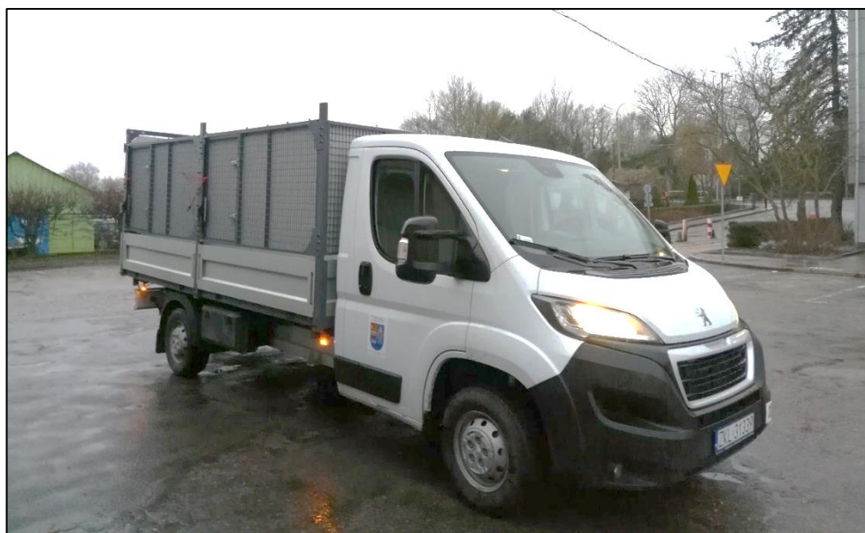
Zdjęcie poglądowe pojazdu typu bajaderka. Podwozie marki: Peugeot; Typ/model: BOXER; Silnik wysokoprężny o poj. 2179 cm 3 i mocy 121 kW; poziom emisji spalin EURO6 AO.
