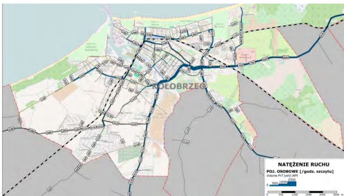
Rysunek 15 Rozkład ruchu w szczycie popołudniowym – samochody osobowe. Źródło: Polityka Transportowa NOF K-G
